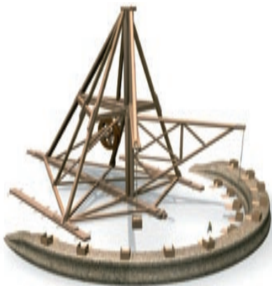
Codice Atlantico, foglio 4r: ricostruzione 3D del progetto per una macchina a doppia gru (©L3)
